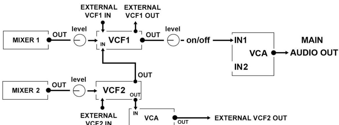
**E/S audios**: Quel que soit le mode, les E/S audios des filtres sont toujours actives via les jacks du panel même si la ligne interne est mutée par le switch on/off (cf usage en standalone du VCF1).
