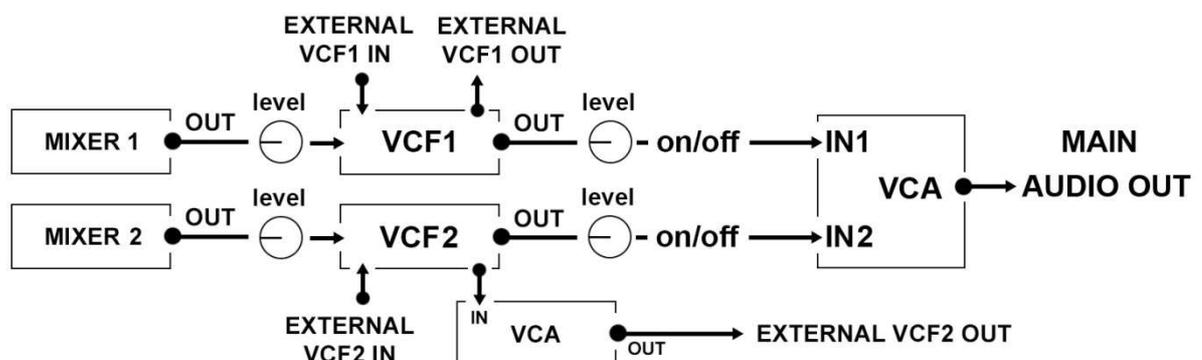
**Mode série 1** : la sortie du filtre 1 est directement routée vers une entrée du filtre 2, ainsi les sources audios du mixer 1 bénéficient du double filtrage. L'interrupteur on/off du filtre 1 est inactif ; celui du filtre 2 coupe la chaîne sonore (dans ce cas aucun son). Les E/S externes restent actives dans ce mode.
