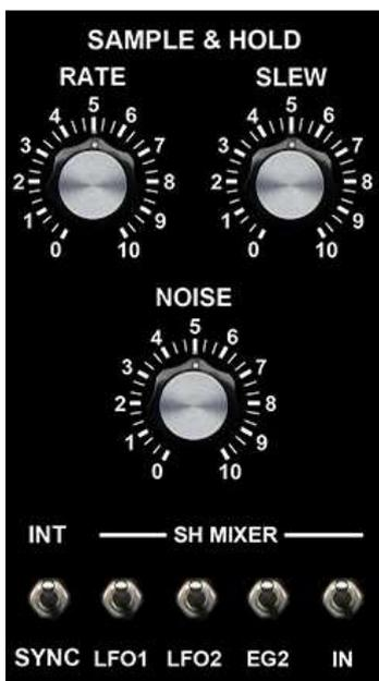
**Sample and hold :** Ce circuit prend une « photo » d'un signal continu selon une cadence réglée par une horloge. Celle-ci est soit interne au circuit (bouton « rate » pour régler la vitesse du LFO interne) soit externe (signal de synchro).
