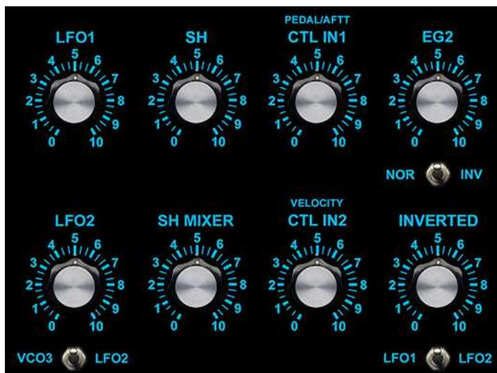
L'Ancestor dispose de **8 sources de modulations** simultanées provenant soit d'un circuit interne (LFO, SH, interface midi...) soit du patchbay
